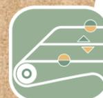
Il guidanastro ReCORR sviluppato appositamente per le macchine di produzione del cartone ondulato, guida le copertine prima del loro accoppiamento finale, permettendovi di ridurre lo spessore della rifilatura, risparmiando così enormi quantità di carta e di denaro in cambio di una qualità elevata e un utilizzo efficiente del materiale.
